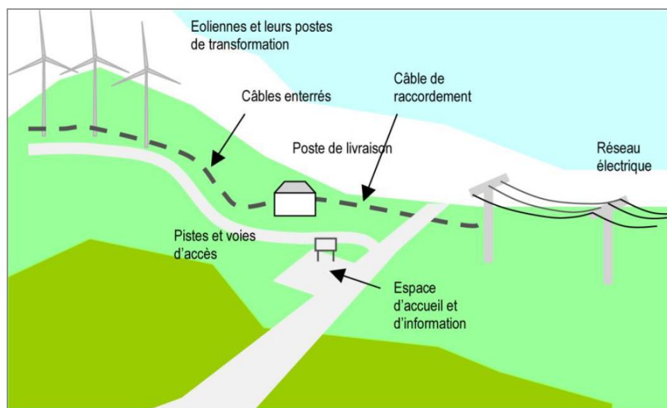
Schéma électrique d'un parc éolien
